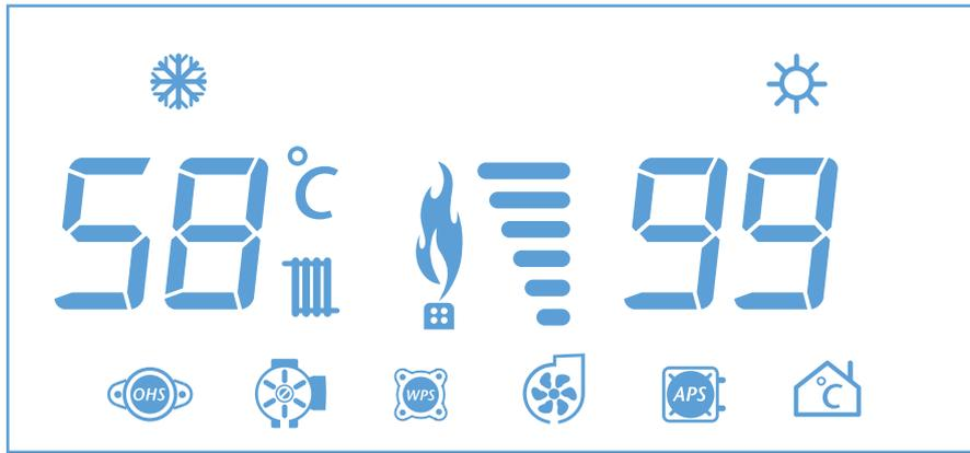
采暖状态时进入大火测试模式：左边数码显示实际采暖出水温度。右边“99”闪烁显示比例阀最大电流输出( 设置后的值 )；
