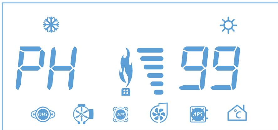
左边数码显示“PH”最大火力设置。右边“99”闪烁显示，接受“暖气 +”或“暖气 -”键输入，数值在 50~99 可调。
