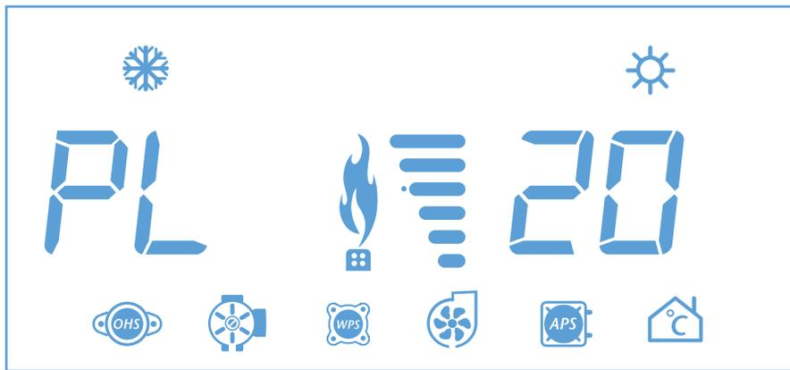
左边数码显示“PL”最小火力设置。右边“20”闪烁显示，接受“暖气+”或“暖气-”键输入，数值在0~49可调。
