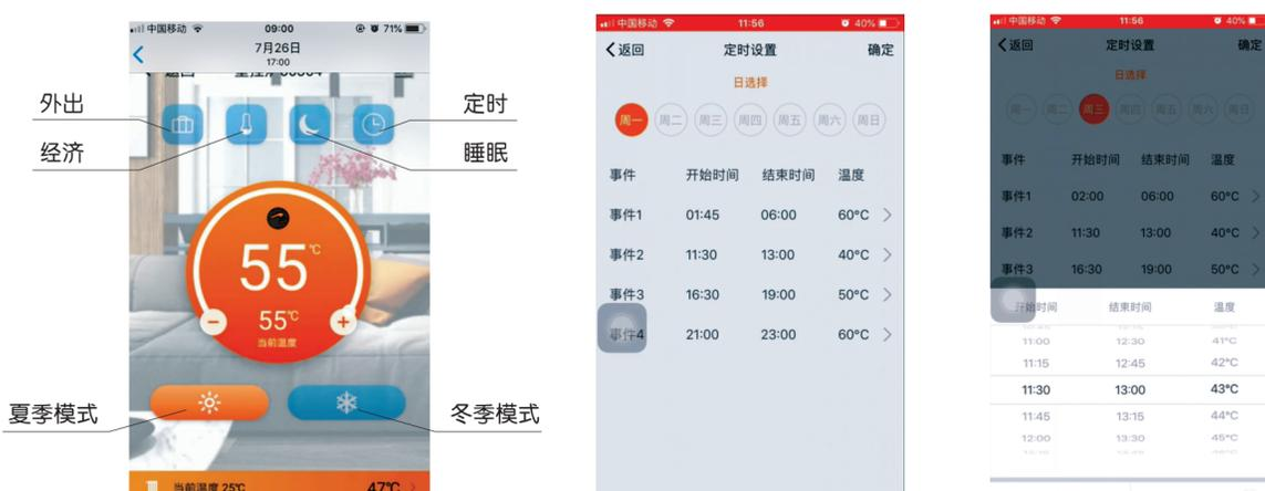
定时界面每个有4个定时段可自定义设置，点击周一设定当天主机工作时段，点击事件1可对当前时段说明进行编辑，例如可将事件1更改为起床。然后前点击当前时段的小箭头可对当前事件的工作时间段进行工作开始时间、结束时间及工作温度进行设定。设定完成后按确认键退出当前时段设置。事件2工作时段设定方法同样。反复操作可对每天壁挂炉的工作时间及运行温度进行预设，全部设置完成后按返回按钮返回主页面。
